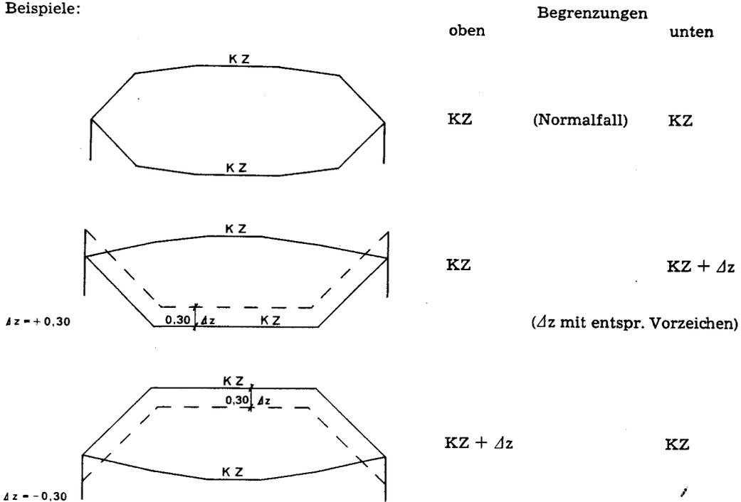
Wird eine Menge zwischen einem Horizont (KZ) und einer Horizontalebene (Z) ermittelt, so wird für die Berechnung der Masse immer die Projektionsfläche der KZ zugrunde gelegt.
