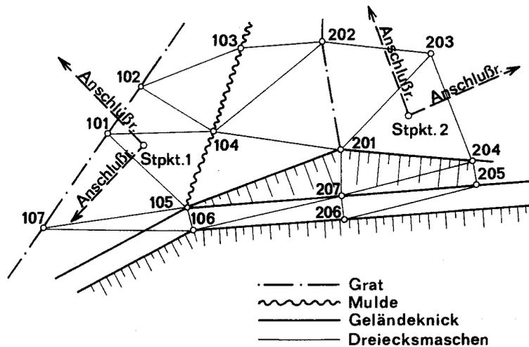
Im gleichen Sinne können auch die Massen verschiedener Bodenarten durch Zwischenhorizonte aufgemessen und berechnet werden.
